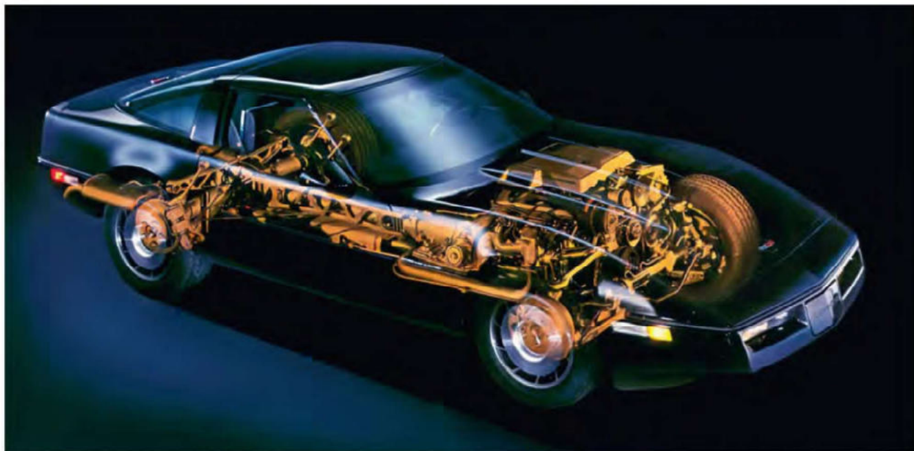
Central delantero. En la radiografía se aprecia bien que el motor está por detrás del eje. Una foto poco artística pero muy ilustrativa de la suspensión trasera: brazos longitudinales [1], bieleta de caída [2], semieje [3], bieleta de convergencia [4], hoja de ballesta [5]. El motor tipo L98 con bloque de hierro, árbol de levas central y cámara en cuña. Lo de la foto torcida en la otra página les puede servir para practicar el contravolante.
