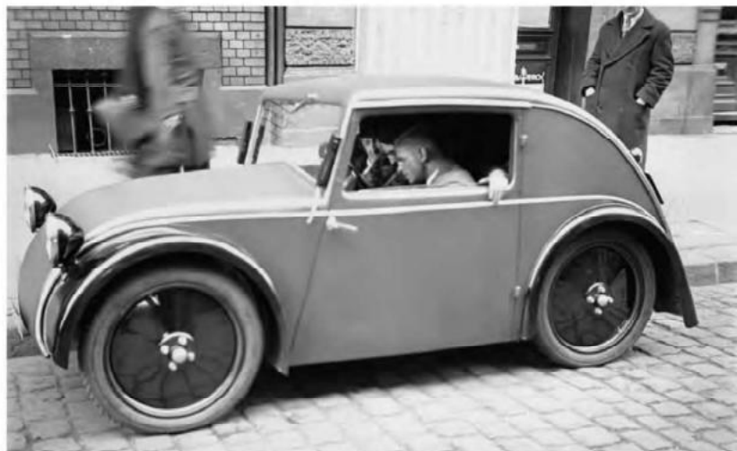
Standard Superior, 1933. El único modelo comercializado según la idea de Ganz fue este microcoche dotado de un pequeño monocilíndrico, situado a la derecha del chasis. Decir que esto es la inspiración del KdF Wagen son ganas de tergiversar.
