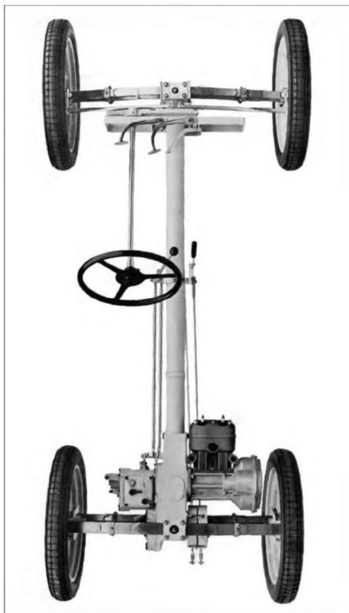
Standard Superior, 1933. El único modelo comercializado según la idea de Ganz fue este microcoche dotado de un pequeño monocilíndrico, situado a la derecha del chasis. Decir que esto es la inspiración del KdF Wagen son ganas de tergiversar.
